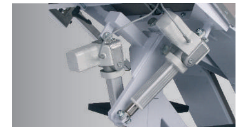
Ajuste de motor para "inclinación" y "ladear"
